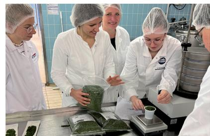
Ermittlung eines Siebaufrißs von getrockneter Petersilie
